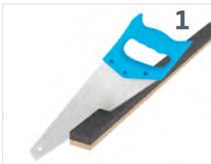
1. Isoleringsstolpen tilskæres med en fintandet sav.
