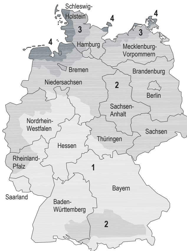
Bild 14: Windzonen nach DIN EN 1991-1-4/NA Anhang A
